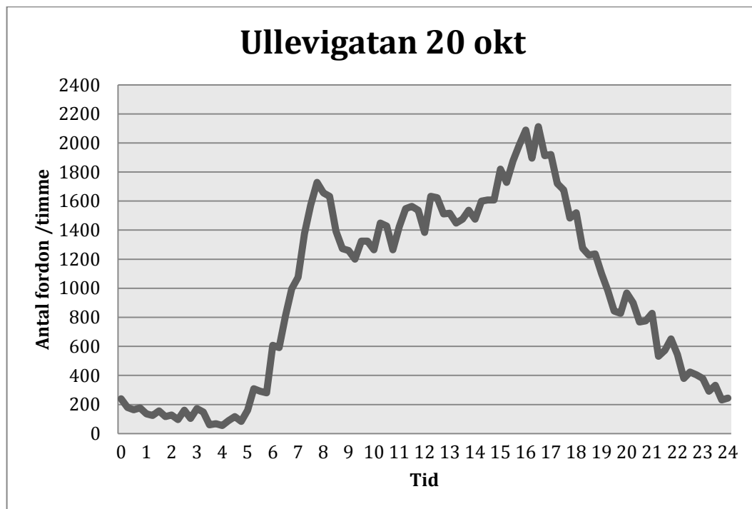
Figur 74 Uppmätt trafikflöde (fordon/timme) i båda riktningarna på Ullevigatan under ett dygn i oktober 2011
