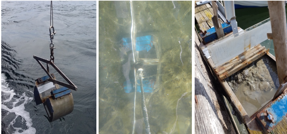
Figur 2. Provtagning av sediment med ponarhuggare. Foto ©Marina Magnusson, Marine Monitoring AB.
