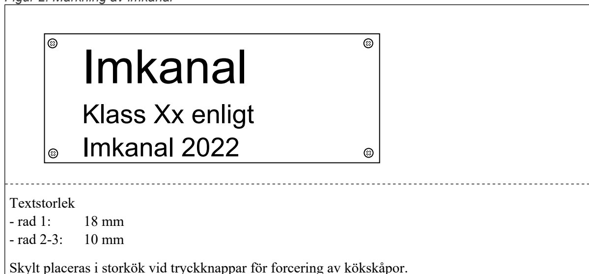
Figur 2. Märkning av imkanal
