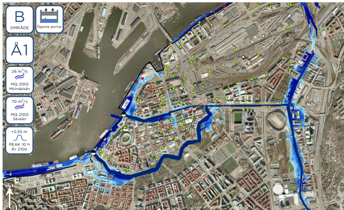
Figur 34 Maximal översvämning i Område B, med högflöde i vattendragen, en 10 timmars peak upp till extremnivå år 2100 och öppna portar.
