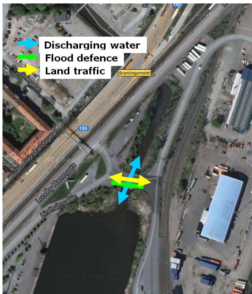
Figur 18. Figuren visar föreslagen funktion i samband med en skyddsport i Kvillebäcken. Bakgrundskarta: Google Maps.
