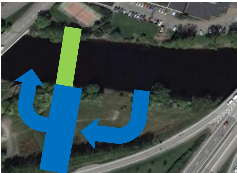
Figur 7. Förslag på placering av skyddsport och pumpstation i Sävåån. Bakgrundskarta: Google Maps.
