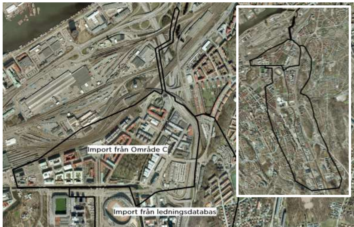
Figur 7 Översikt av källan till ledningsnätsupplysningar i MIKE Urban modellen. Ledningarna har importerats från modellen för Område C och för övrigt har Kretslopp och Vattens ledningsdatabas använts. Den infällda bilden visar hela modellområdet för MIKE Urban modellen.
