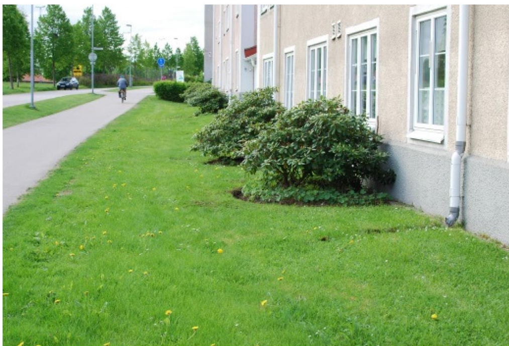
Figur 7-5 Exempel på svackdike.
