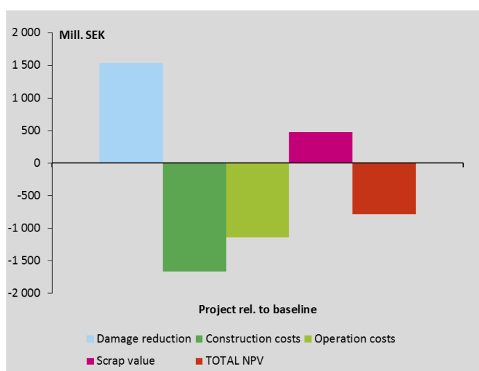
Figur 4-3 Redovisning av resultat från hydromodellens kostnads-nyttanalys (kalkylark i Excel). Resultatet som visas är för Yttre barriär (Ramböll, 2014). "Scrap value" är anläggningens bedömda restvärde vid tidshorisontens slut.
