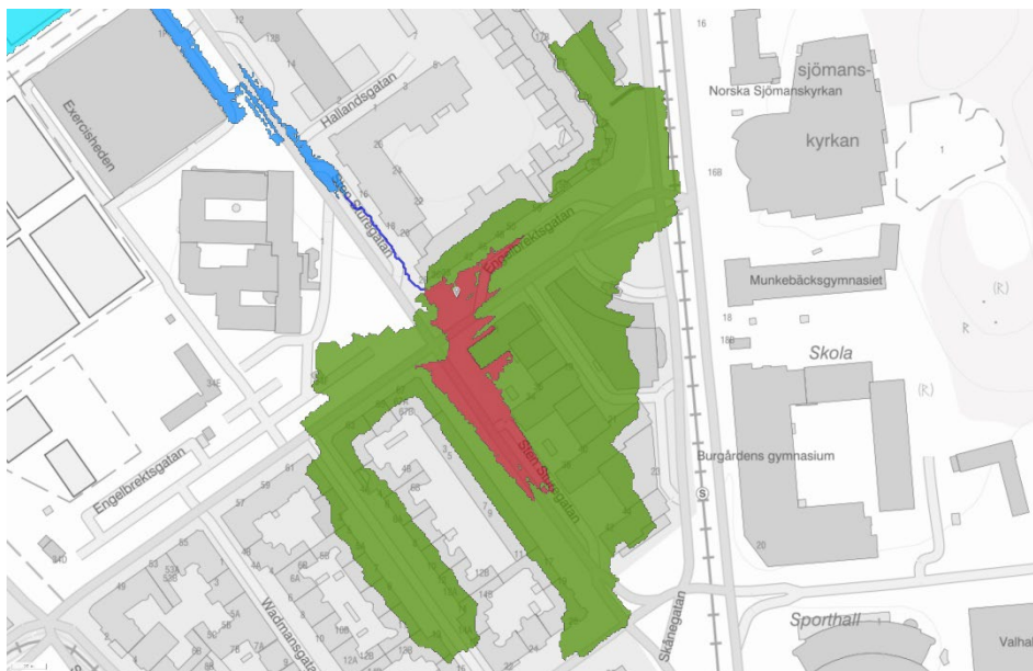
Figur 4.6 Ytligt avrinningsområde (grönt) till lågpunkt (rött) vid korsningen Engelbrektsgränd/Sten Sturegatan. Bild: Scalgo Live.
