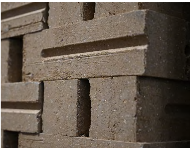
CEB-sten tillverkad på Cycle Terre
