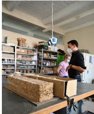
Provbit av stampad jord på laboratoriet.
