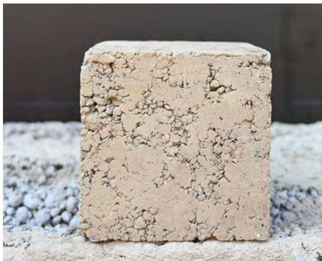
Provkub av jordblandning som ska testtryckas inför byggnation
