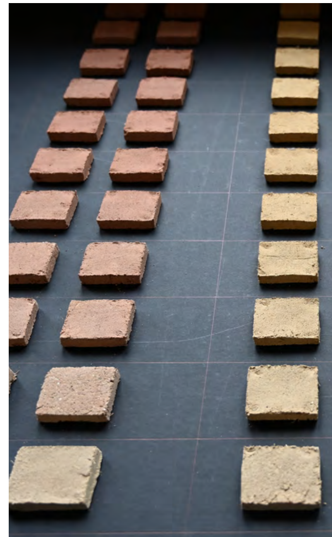
Färgprover på tork i laboratoriet inför tillverkning av CEB-sten
