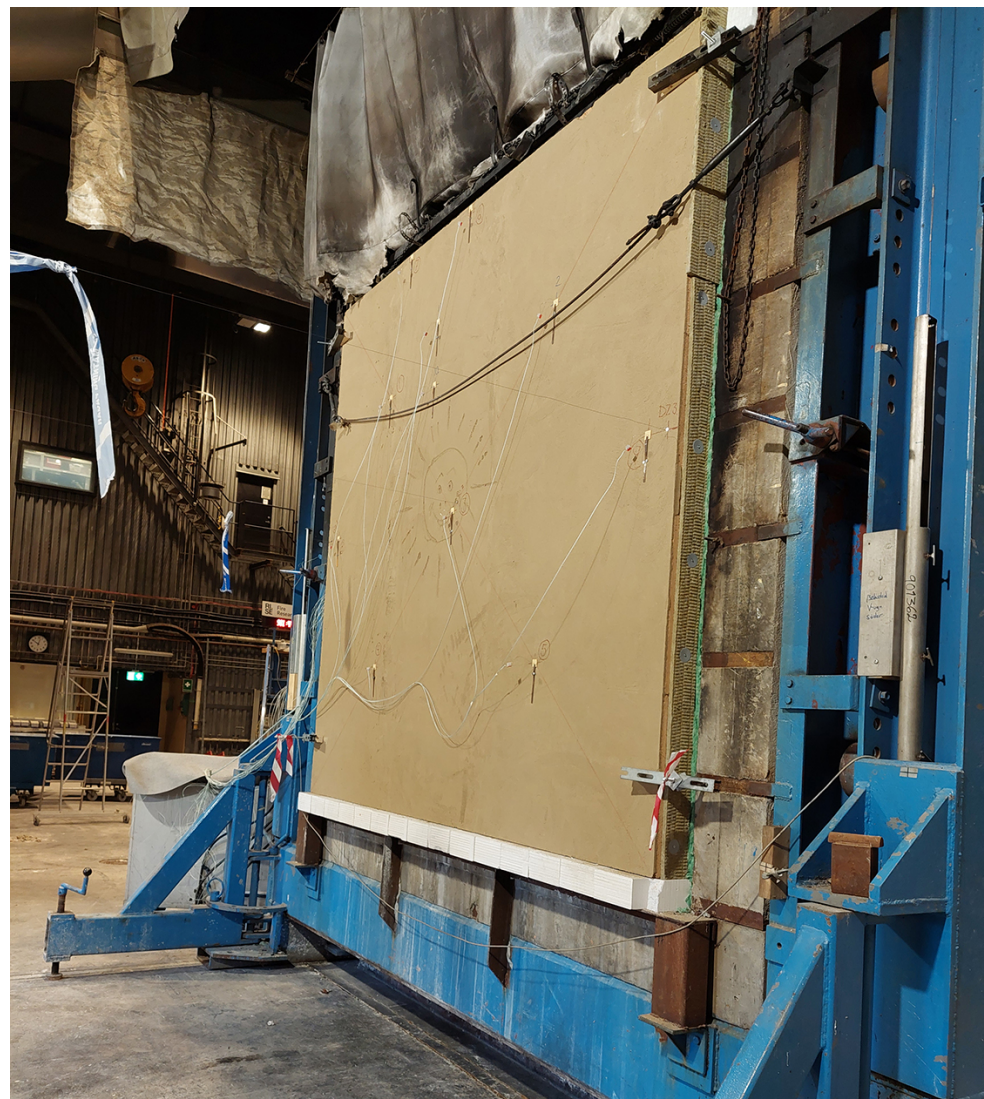
Förberedelse av vägg för brandtest hos RISE.
