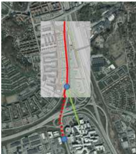
Bild: Tänkt utförande (söder om leden) Spåret bör läggas i mitten av vägen för att lämna grönytan vid sidan av vägen till bostäder/verksamheter eller just grönområden.
