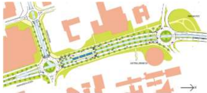
Bild: Tänkt utförande (söder om leden) Spåret bör läggas i mitten av vägen för att lämna grönytan vid sidan av vägen till bostäder/verksamheter eller just grönområden.
