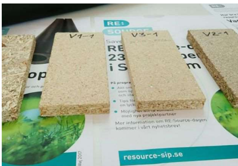
NSR - spånplattor tillverkade av återvunnet trä och fossilbaserat lim
