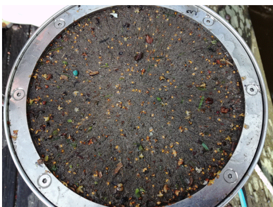
Figur 3. Filter från prov M2_2 med mycket organiskt material som behandlades med 30% väteperoxidlösning innan analys.
