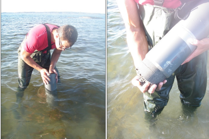
Figur 3. Insamling av bottenfauna med en cylinderprovtagare i undersökningslokal Norra Galterö. Cylinderprovtagaren pressas ned 15 cm i havsbotten (bild till vänster) därefter grävs röret upp ur havsbotten, innehållande ett infaunaprov (bild till höger).
