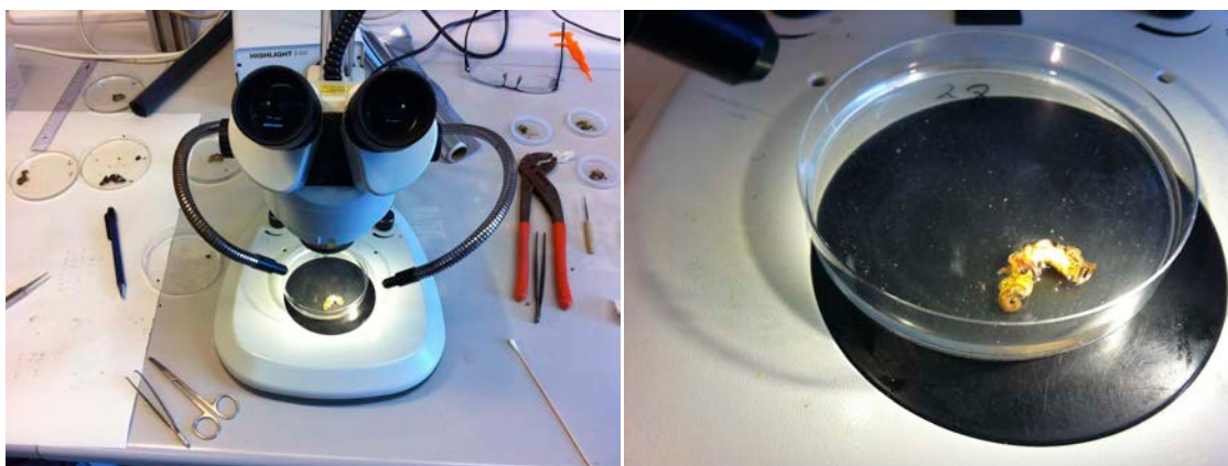
Figur 3. Bestämning av imposex utfördes i stereomikroskop efter det att snäckorna sövts med 7% mgCl 2 .
