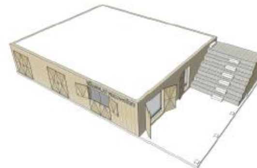
3. ISOLERAT "SKAL", TERRASS OCH LÄKTARTRAPPA
