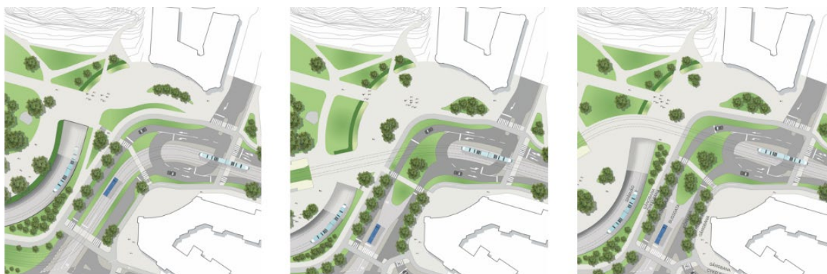
Figur 29 Jämförelse av den rundade formen vid Slottsskogens huvudentré. Längst till vänster illustreras Västligt alternativ, i mitten Östligt alternativ 1 och till höger Östligt alternativ 2.
