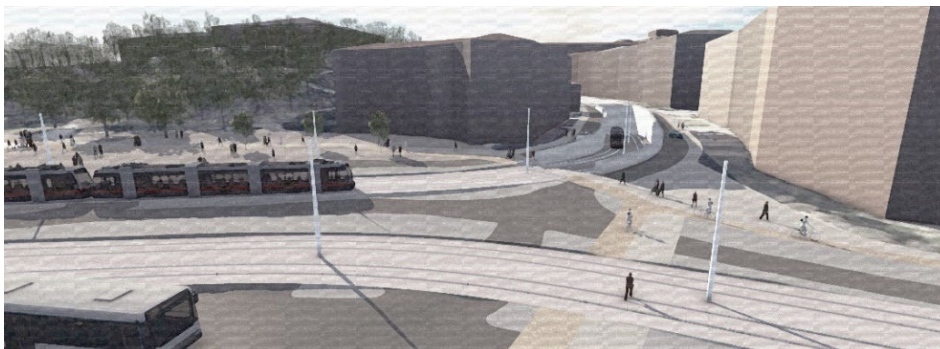
Figur 60 Alternativ Tråg i Rosengatan. Vy från Linnéplatsen mot Rosengatan. Lindholmsförbindelsen går i tråg längs Rosengatan och i höjd med Alfhemsgatan leds spårvägen in i en betongtunnel.
