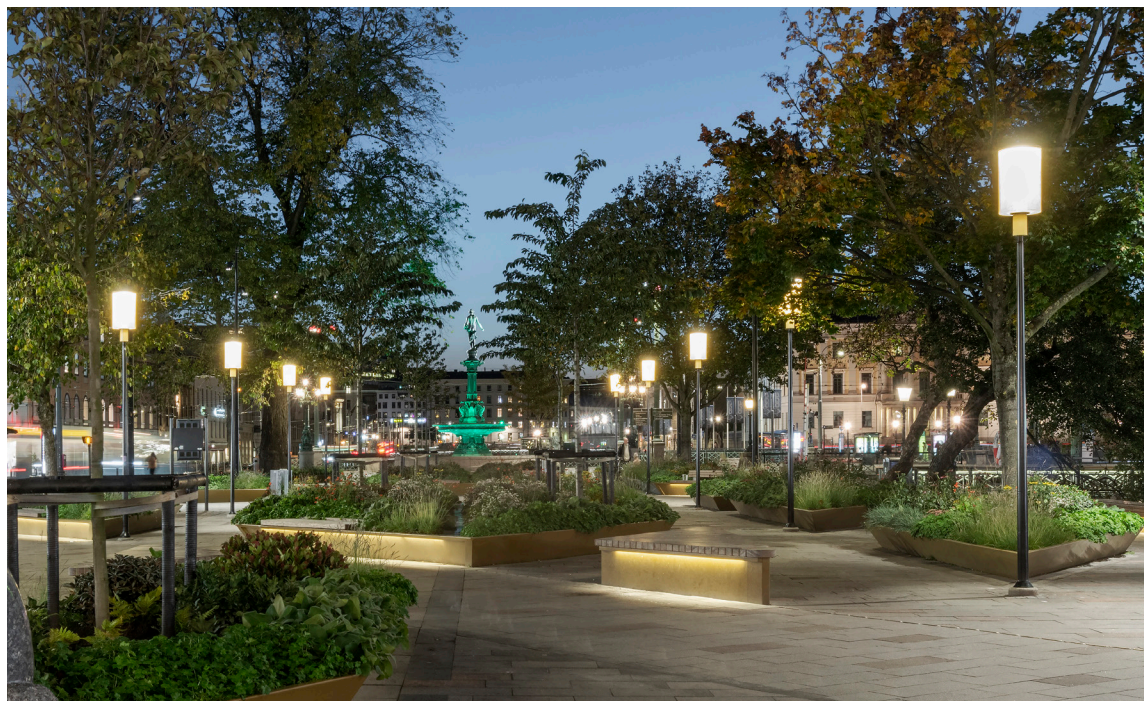
Brunnsparken, centrala Göteborg. Ljussättningen gör hela parken väl synlig och inbjudande även under årets mörka timmar, utan att den känns överbelyst. Utöver ett jämnt allmänljus från spotlights på master ger vänligt skimrande lyktor ljus på vertikala ytor samt ljus i samspel med vatten och vegetation, stämning och dynamik. Foto: James Silverman/ White arkitekter
