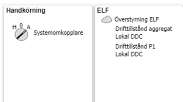
Figur 2 Systemets ELF indikering för ett luftbehandlingsaggregat
