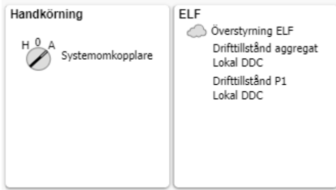
Figur 2 Systemets ELF indikering för ett luftbehandlingsaggregat
