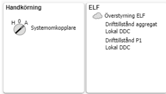
Figur 2 Systemets ELF indikering för ett luftbehandlingsaggregat
