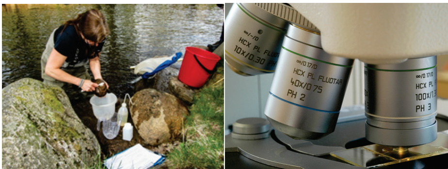
Figur 2. Provtagning av kiselalger görs i första hand genom borstning av stenar varefter kiselalgspreparat framställs och analyseras i ljusmikroskop med 1000 gångers förstoring (objektiv 100x).
