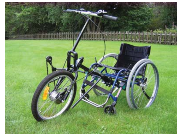
Armdriven cykel för montering på rullstol
