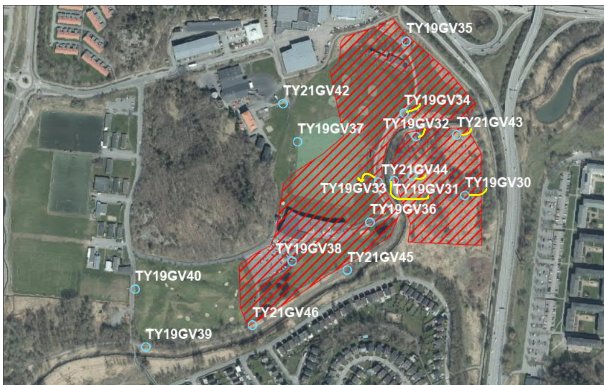
Figur 2 Översiktskarta över provtagningspunkter för grundvatten. De nyinstallerade grundvattenrör från 2021 användes även för jordprovtagning. De gula sträckan är förtydligande vilket rör som tillhör vilket namn. För tydligare bild se Bilaga 3a
