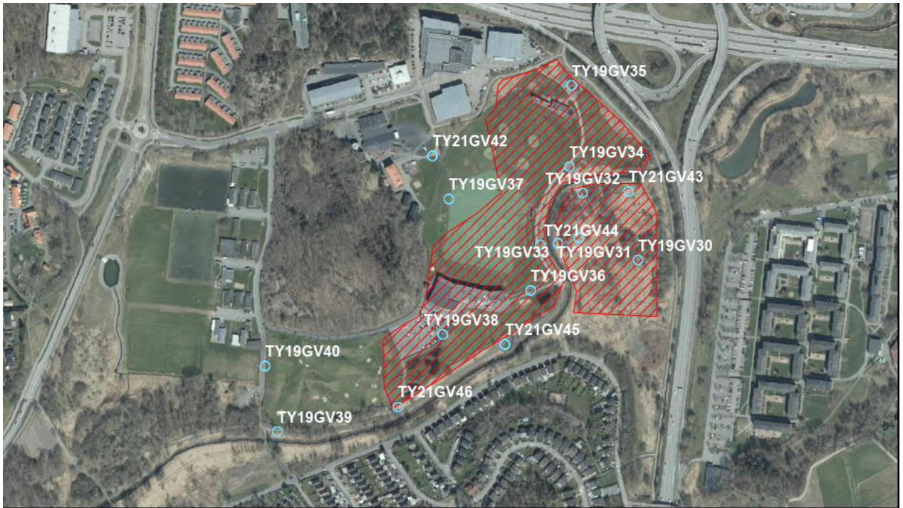
Figur 6 Befintliga grundvattenrör (TY19GV30-40) och med de nya kompletterande rören (TY21GV 42-46). En tydligare bild redovisas i bilaga 1:2
