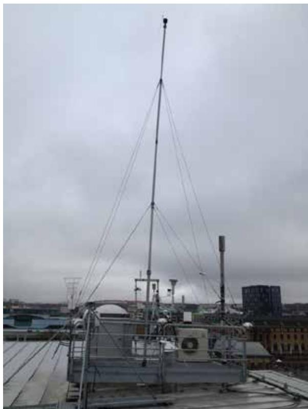
Här har vår huvudstation legat sedan 1987. På plattformen på taket finns intagen till mätinstrumenten och den meteorologiska utrustningen. Här mäts vindriktning och hastighet, temperatur, fuktighet, lufttryck och solinstrålning. Här tas också månadsprov av nederbörd för analys.
