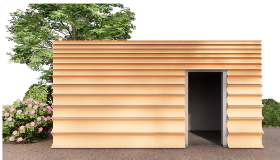
Fig.25: Horisontellt monterade rör i fallande dimension med konkav sida utåt.
