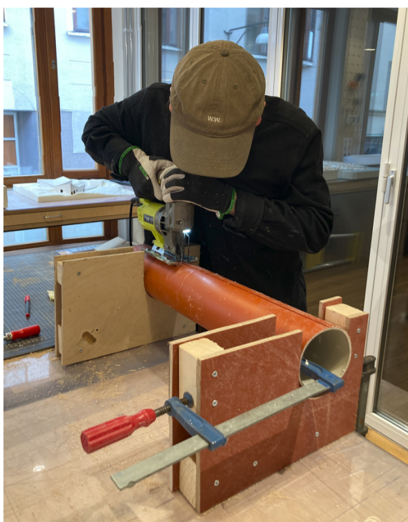
Fig.17: Längsgående kapning med sticksåg, röret fastspänd i jigg.
