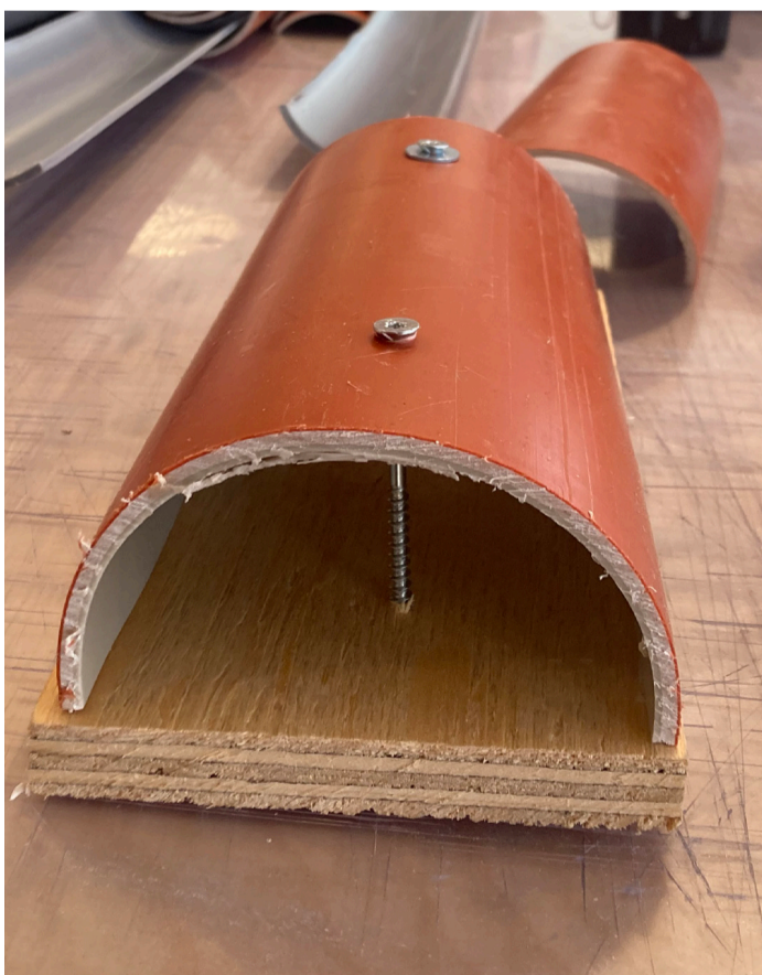
Fig. 21: Montering – skruv med underliggande bricka föredras i förborrade hål. Långa skruvar krävs för infästning av halvor enligt bild.
