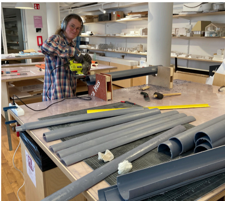
Fig.19: Rören kapas i halvor, tredjedelar och fjärdedelar.
