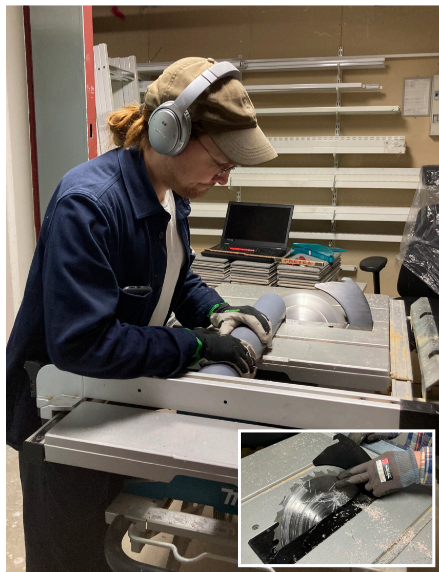
Fig.14&15: Gersågning med stationär cirkelsåg samt konsekvensen av att såga plast med klingan.
