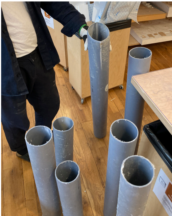
Fig.16: Rör i varierat skick, de deformerade bitarna kapas bort
