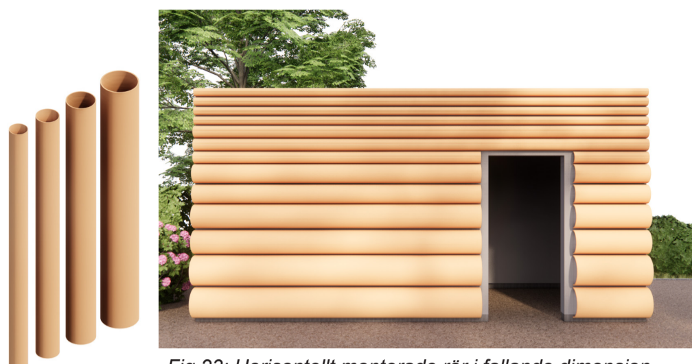
Fig.23: Horisontellt monterade rör i fallande dimension.
