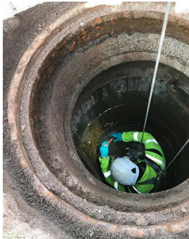
Figur 11 Nere i nedstigningsbrunnen sker mätningar och provtagningar (Punkt TY19DS J)
