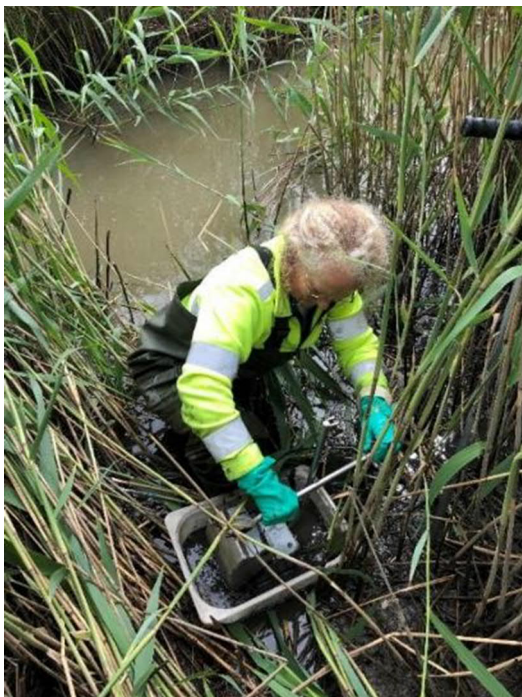
Figur 13 Provtagning med Van Veen-huggare i löst och djupt sediment
