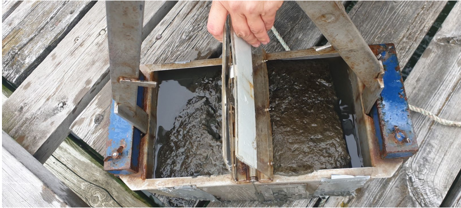
Figur 3. Provtagning av sediment med ponarhuggare. Fotograf Marina Magnusson, Marine Monitoring AB®.
