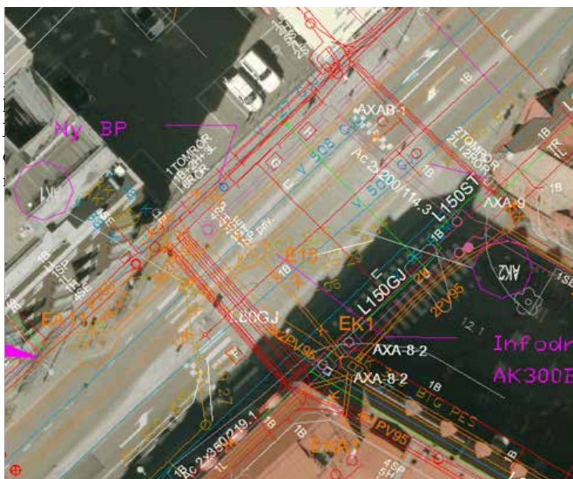
Figur 9: Utdrag ur samlingskartan visar att marken under gatan redan idag rymmer en mängd infrastruktur och ledningar som begränsar möjlighet att utöka avledning i ledningar under mark.
