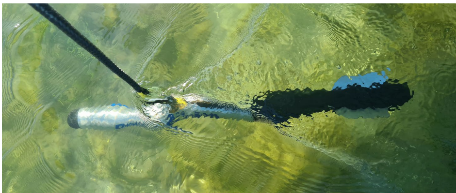
Figur 3. Side-scan sonar som användes i fält för att avgränsa ålgräsängarnas areella utbredning.
