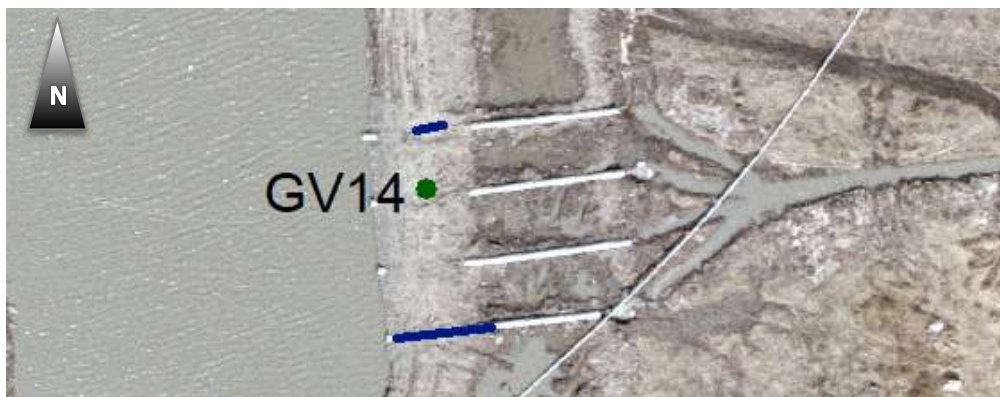
Figur 18. Dräneringsrör och GV14 i sydöstra delen av deponin på ortofoto från 1977 (Lantmäteriet). Blåa streck visar ungefärligt läge för de två dräneringsrör som påträffades vid den okulära kontrollen i maj 2021. Illustrationen är baserad på inmätningar av rörens in- och utlopp.
