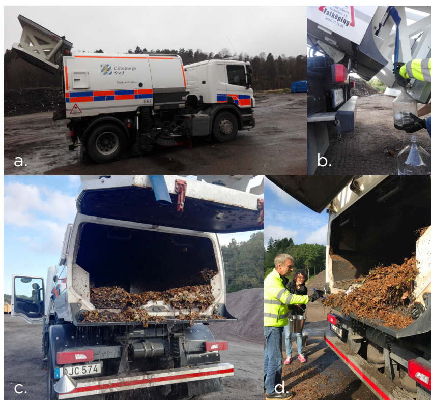
Figur 6. a. Öppning av luckan på gatusopningsmaskinen för tömning av gatusopningssand och gatusopningsvatten; b. Provtagning av gatusopningsvatten; c. Provtagning på gatusopningssand som vid detta tillfälle mestadels bestod av löv; d. Lövfylld gatusopningsbil. Bilder: Maria Aronsson och Maria Polukarova
