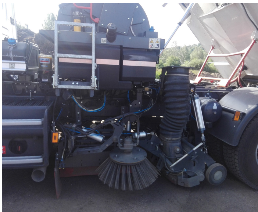
Figur 4. Gatusopningsbilen utrustad med borstar av stål och dess uppsugningssystem. Foto: Maria Polukarova
