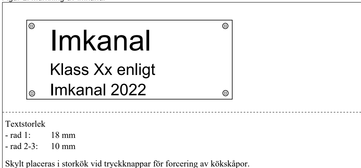
Figur 2. Märkning av imkanal
