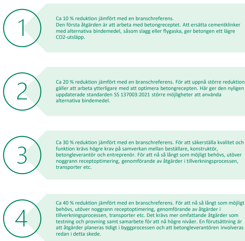
Figur 47: Fyra nivåer av klimatförbättrad betong i enlighet med Svensk Betongs Vägledning för klimatförbättrad betong. Vilken nivå som är möjligt att nå i ett specifikt projekt kan begränsas av regelverk och produktionstekniska förutsättningar (114).
