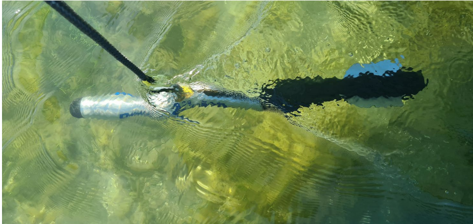
Figur 3. Side-scan sonar som användes i fält för att avgränsa ålgräsängarnas areella utbredning.
