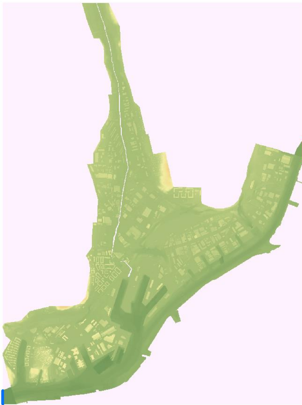
Figur 12 Översikt av MIKE 21-modellen som används vid simulering av Kvillebäcken. Den blå linjen visar var nedströms vattennivå kopplas till MIKE 21-modellen som ett randvillkor. Den röda linjen visar var uppströms flöde kopplas till MIKE21-modellen som ett randvillkor.
