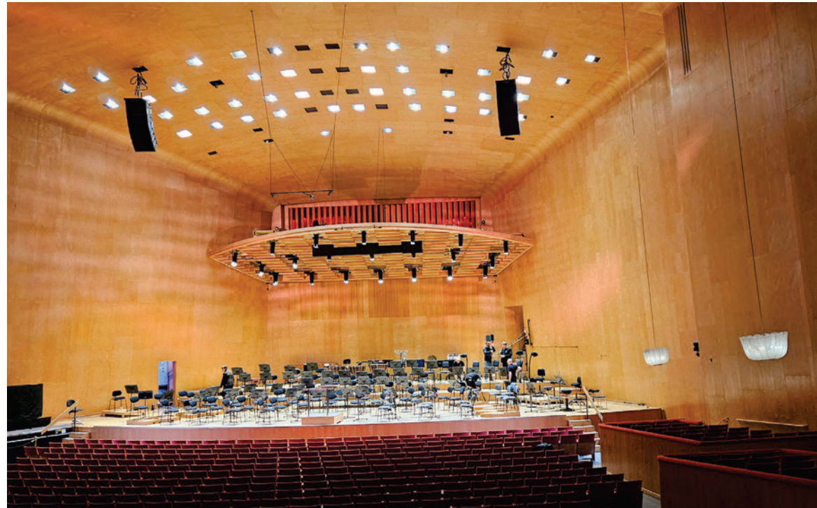
STORA KONSERTSALEN MED SCENEN OCH BALDAKINTAKET ÅR 2024. VÄGGARNA BEVARAR SIN URSPRUNGLIGA FANÉR AV SYKOMORLÖNN. BALDAKINEN ÄR FRÅN 2021 OCH ERSATTE DÅ EN TIDIGARE, MEN EJ URSPRUNGLIG, BALDAKIN. DEN NÅS IDAG ENDAST FRÅN SKYLIFT. FÖR ATT FÖRBÄTTRA ARBETSMILJÖN OCH SKAPA EN NY TILLTRÄDESVÄG AVSES EN LUCKA TAS UPP I VÄGG I BALDAKINENS BAKKANT (SE VIT PIL FÖR UNGEFÄRLIGT LÄGE). DE UTRYMMEN I KONSERTHUSET SOM BERÖRS AV ÅTGÄRDERNA ÄR DEN FRÄMRE DELEN AV DEN KULTURHISTORISKT VÄRDEFULLA STORA KONSERTSALEN SAMT VÄGG MELLAN KONSERTSALEN OCH ETT TEKNIKUTRYMME I PLAN 5 (FLÅKTRUM 504).
