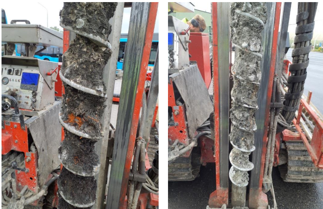
Figur 4. Fyllnadsmassor innehållande grus, sten och sand i provpunkterna 25LC01 1-2 m under markytan (vänster) och 25LC02 0,6-1 m under markytan (höger) varav inslag av tegel i den vänstra (Foto: Lovisa Brandt)
