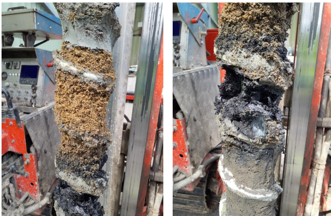
Figur 5. Provpunkt 25LC08 varav den vänstra bilden visar sågspånet på nivån 2,2-2,5 m under markytan och den högra bilden visar den oljedränkta träflisen på nivån 2,5-2,6 m under markytan (Foto: Lovisa Brandt).
