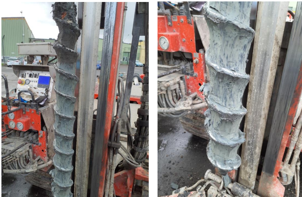
Figur 6. Provpunkt 25LC02 2-3 respektive 3,5-4 m under markytan som visualiserar den bedömt naturliga leran (Foto: Lovisa Brandt).
