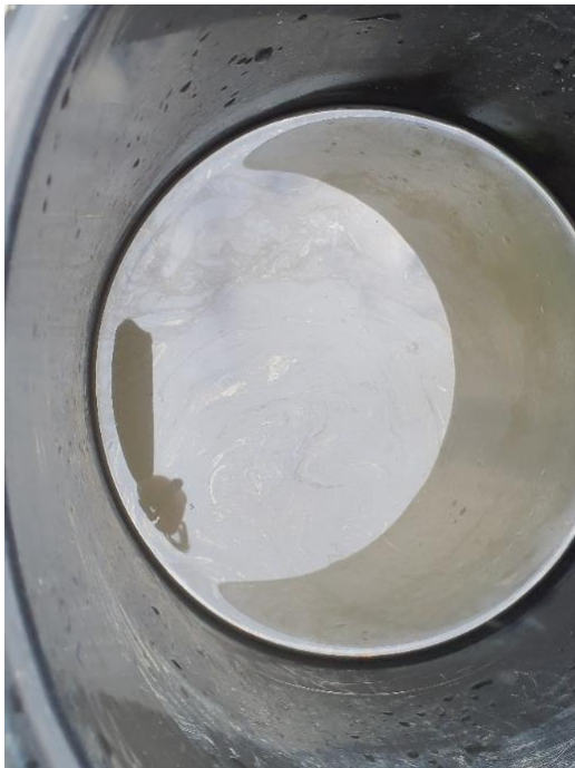
Figur 7. Foto över rensumpat vatten i provpunkt 25LC06 med en tydlig oljehinna (Foto: Lovisa Brandt).
