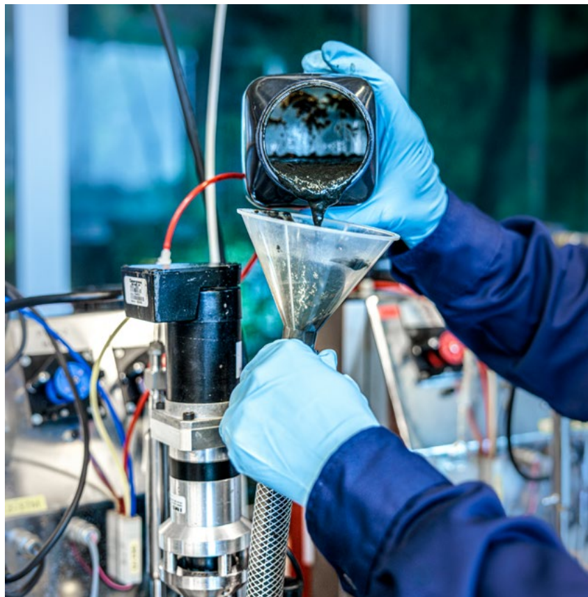
Slammet fylls på i en av reaktorerna i Gryaabs försökslaboratorium.
