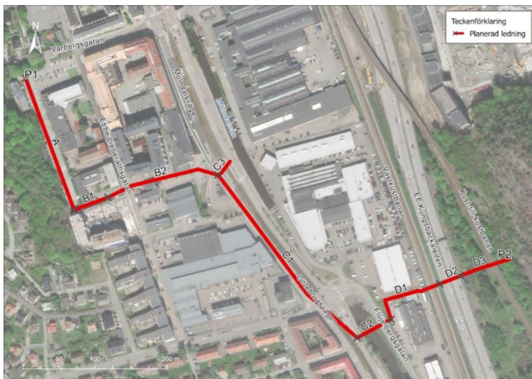
Figur 2 Planerad ledningssträckning i öst-västlig riktning under Gamla Boråsbanan, E6.an, stambanan, Mölndalsån samt Mölndalsvägen
