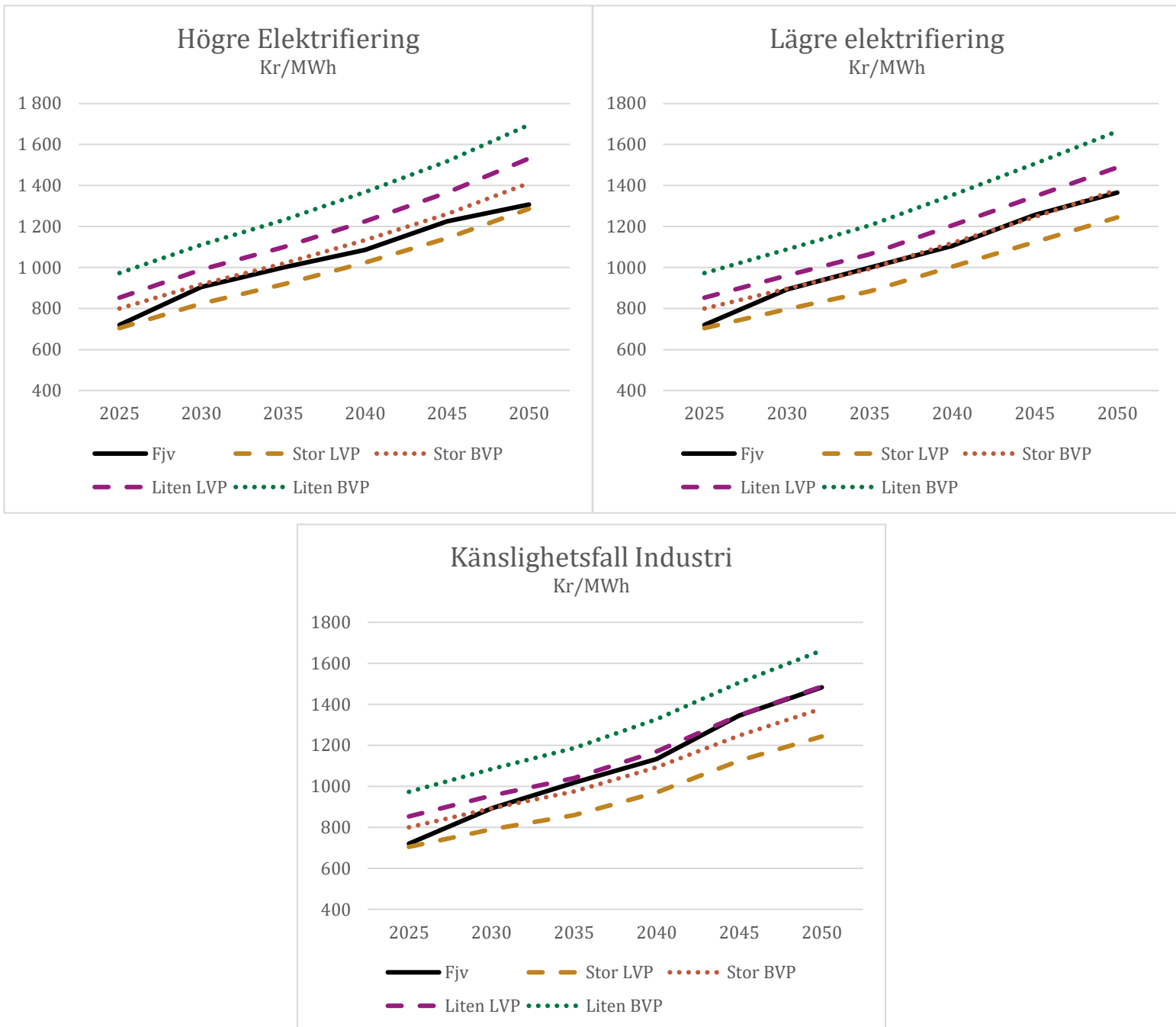
Figur 18: Fjärrvärmekostnader och värmepumpskostnader för kund per MWh för scenario Högre Elektrifiering, Lägre Elektrifiering och Känslighetsfall Industri. Värmepumparna delas upp i luftvärmepump (LVP) och bergvärmepump (BVP) för stor respektive liten kund.
