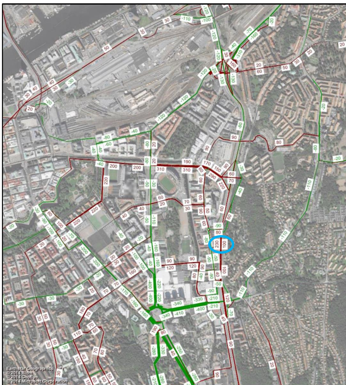
Figur 3. Förändring i trafikflöden med Korsvägen, Svingeln och Lisebergs förändringar, jämfört med en modell för nuläget. Rött motsvarar en ökning av trafik, grönt en minskning. Det är förhållandena under eftermiddagens maxtimme som illustreras.
