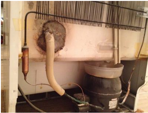
Figur 14 Skadas kylmediekretsen i uttjanta vitvaror kan klimatpåverkande gaser läcka
