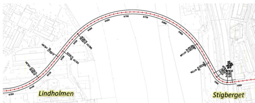
Figur 10. Alternativ 27 m bro, urklipp ur spårplan som visar Göta älvpassagen.
