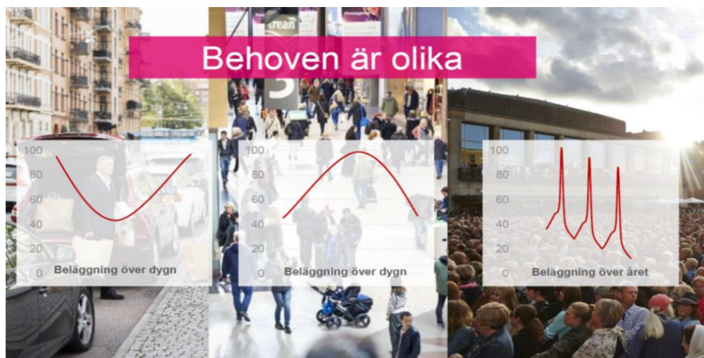
Figur 3. De två första figurerna visar schematiskt beläggningsmönster för parkeringsytor som huvudsakligen används för boende- respektive arbetsplatsparkering och visar en naturlig potential för samutnyttjande. Den sistnämnda speglar schematiskt beläggningsmönstret i samband med evenemang.
