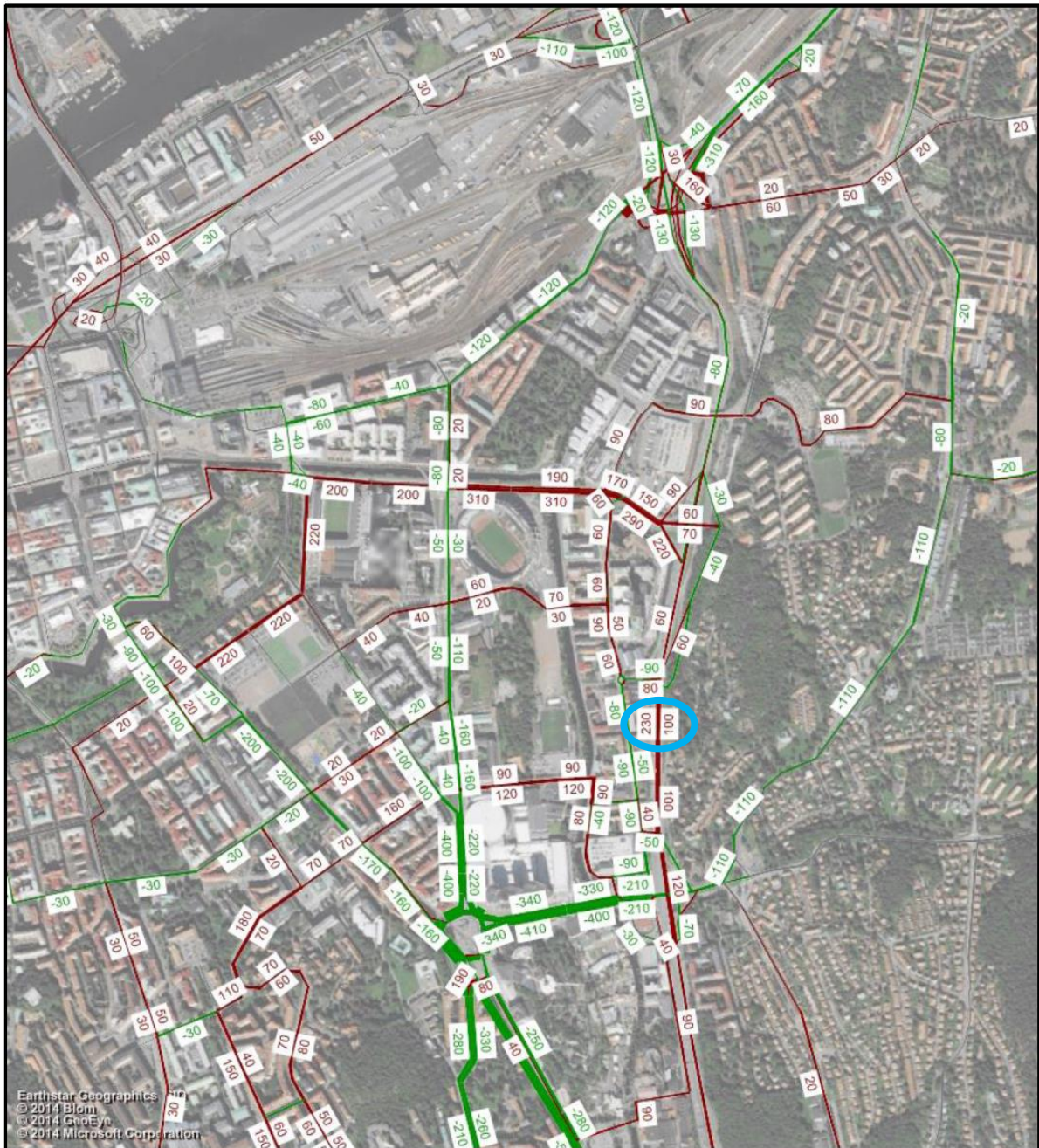
Figur 3. Förändring i trafikflöden med Korsvägens, Svingelns och Lisebergs förändringar, jämfört med en modell för nuläget. Rött motsvarar en ökning av trafik, grönt en minskning. Det är förhållandena under eftermiddagens maxtimme som illustreras.
