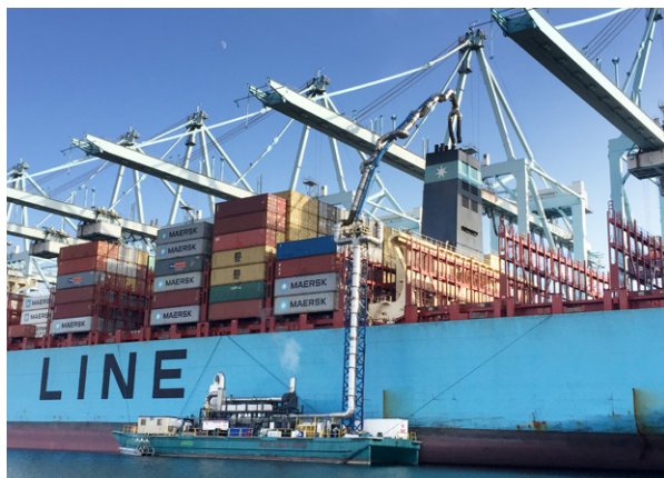
I Los Angeles hamn används reningssystem för fartyg – här ses när kopplingen är ansluten till fartygets skorsten.
