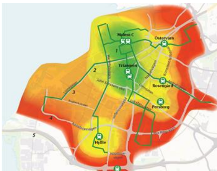
Figur 4. Zonindelning för flerbostads och verksamheter. Gröna linjer är planerade linjedragningar för Malmöexpressen. Områdena utanför kartan tillhör zon 5 22 .
