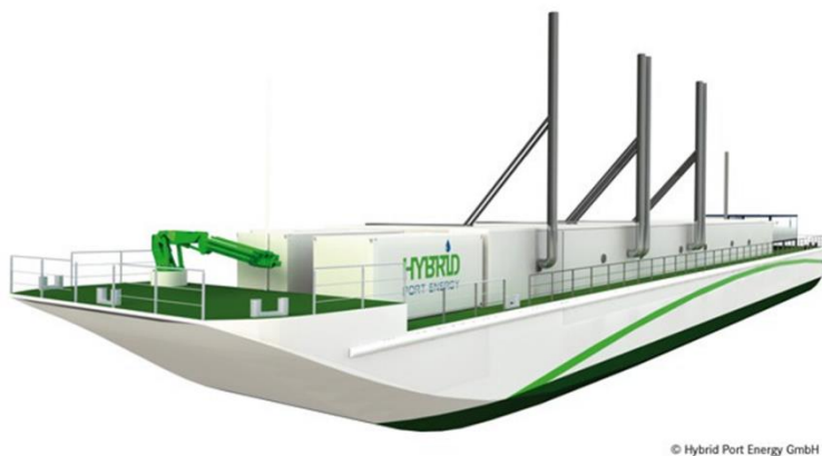
Figur 10. Modell över en pråm med elproduktion som drivs med LNG
