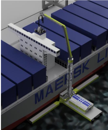
Figur 9. Anläggning med mobil scrubberteknik
