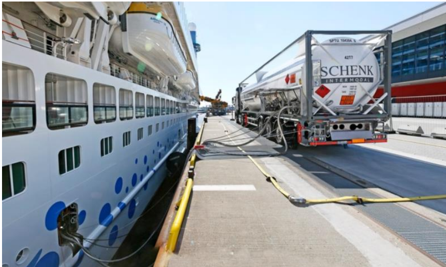
Figur 12. Kryssningsfartyg bunkras från LNG-lastbil i Hamburg. Bild: AIDA Cruises
