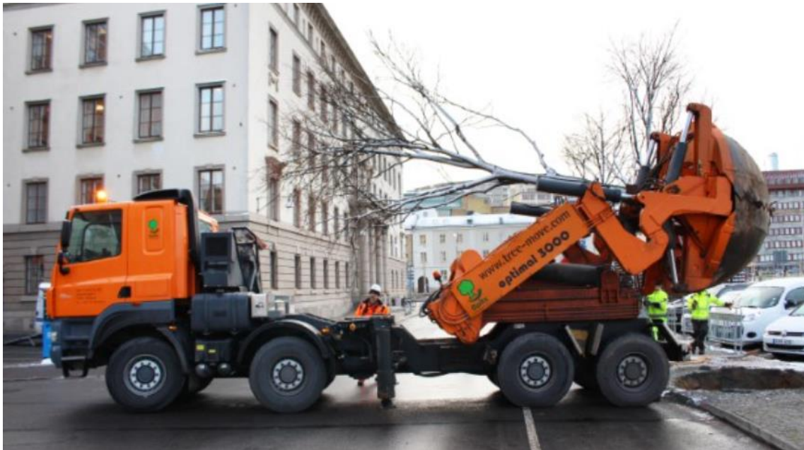
Figur 18. Flytt av träd med hjälp av Trädflyttmaskiner inom de förberedande arbetena för Västlänken i Göteborg. Foto Örjan Stål
