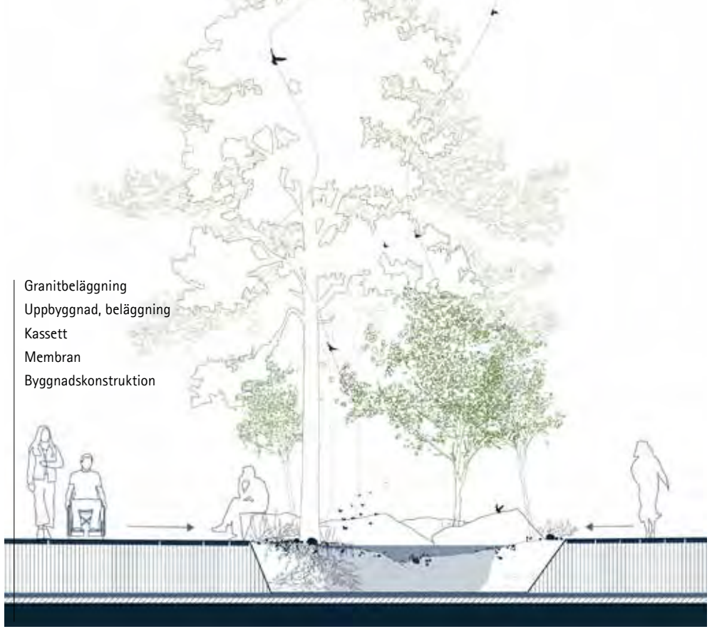
Principsektion för dagvattenhantering, planteringssprickor
