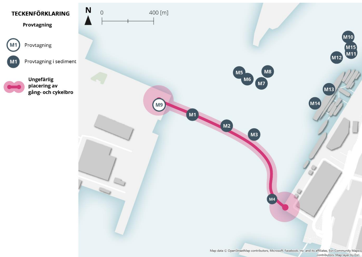
Figur 35. Provtagning i sediment, utförd år 2006 i samband med utredningen av den tidigare gång- och cykelbron.
